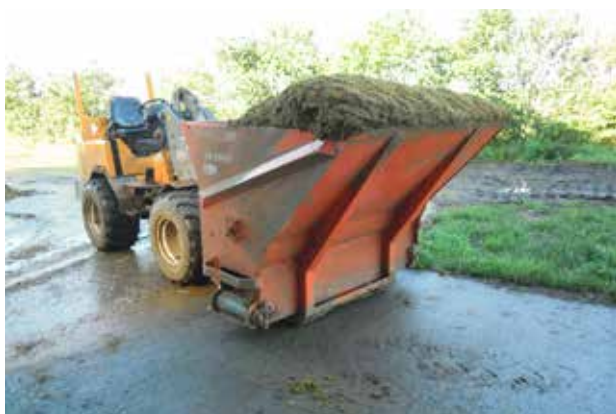
Figur 2.3. En strøkasse på en minilæsser anvendes både til at strø fiber på madrasser og i kummer.
