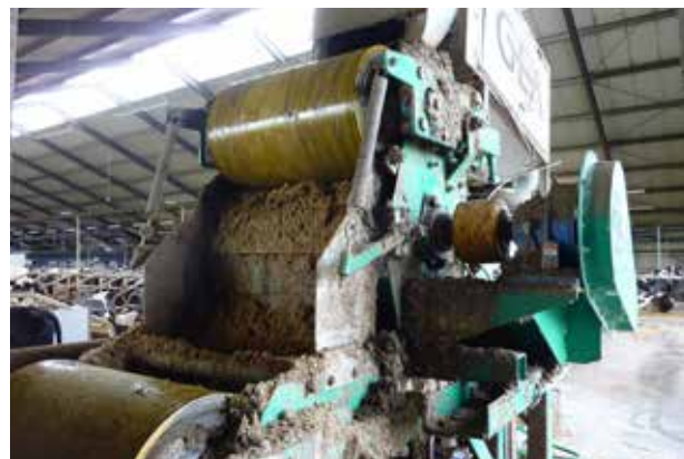
Figur 2.14. Mange kvægbrugere oplevede opstartsproblem, bl.a. kunne tromlesien stoppe til.
